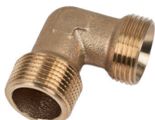
Roth vinkel 3/4" EURO-red x 3/4" nippel Anvendes sammen med Roth fordelerkoblinger. VVS-nr. 045694.406
