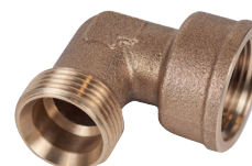
Roth vinkel 3/4" EURO-red x 3/4" muffe Anvendes sammen med Roth fordelerkoblinger. VVS-nr. 045694.436
