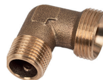
Roth vinkel 3/4" EURO-red x 1/2" nippel Anvendes sammen med Roth fordelerkoblinger. VVS-nr. 045694.333
